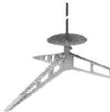
La rampa di lancio fornisce la necessaria stabilità al decollo. Essa consiste in una lunga asta metallica che permette di stabilire la direzione, (lunga almeno 90 cm) ed un deflettore metallico che impedisce ai gas di colpire direttamente il terreno. Entrambi sono montati su un supporto a treppiede. Il modello viene montato sulla rampa inserendo l'asta negli anelli di lancio del modello.
